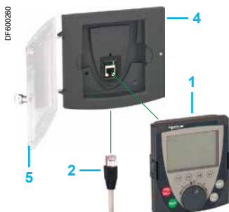
Uso del terminale grafico remoto sulla porta di un armadio: 1 + 2 + 4 (+ 5, se IP65)
